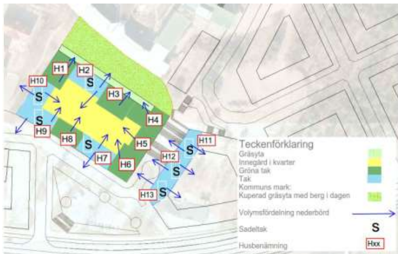
Figur 6. Taklutningar enligt Dagvattenutredning Detaljplan Kv Brytaren samt Brytaren mindre, Nacka stad 20170218.
